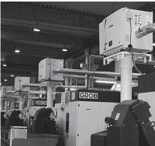
하나의 필터기 - 하나의 장비 Premium Aerotech에서 설치한 A•mist 10C
